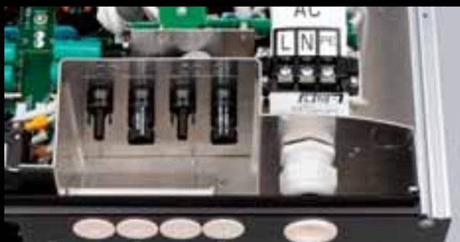
La carcasa metálica de aluminio está cerrada herméticamente para que, en caso de incendio en el interior del inversor, las llamas sean contenidas en este evitando la difusión del fuego.
